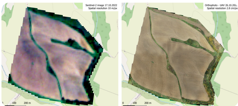
Fig. 4: Vergleich eines Sentinel-2-Satellitenbildes in Echtfarbe mit einer Auflösung von 10 m/Pixel und einer von einem UAV aufgenommenen Orthofotokarte mit einer Auflösung von 2,8 cm/Pixel mit sichtbaren Erosionsfurchen, die auch für detailliertere Analysen, z. B. die Berechnung des erodierten Materials, verwendet werden können.
