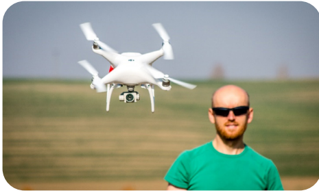
Abb. 2: Kleine, billige Drohnen können jetzt Orthofotokartendaten mit einer Auflösung von Zentimetern pro Pixel aufnehmen.
