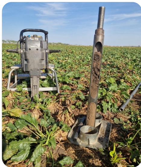
Fig. 1: Campionamento del terreno indisturbato per identificare il profilo dei nitrati in un campo a seminativi.
