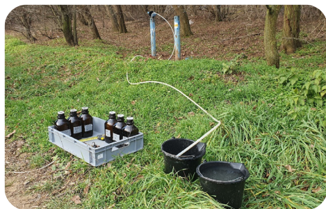
图2 采集浅层地下水样本以监测硝酸盐
