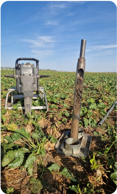
图1 钻探、未扰动土壤采样以识别可耕地下的硝酸盐剖面
