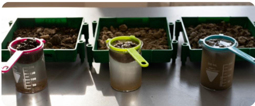
Obr. 4: Výsledky testu stability půdních agregátů (viz aplikace TUDi DST), provedeného pomocí sítka na čaj, sklenice a vody. Stabilita půdní struktury klesá směrem zleva doprava.
