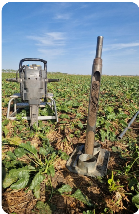
Obř. 1: Vrtaný, neporušený odběr vzorků půdy k identifikaci profilu dusičnanů pod svrchní vrstvou půdy.
