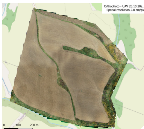
Obr. 4: Srovnání barevného satelitního snímku Sentinel-2 s rozlišením 10 m/pixel a ortofotomapy pořízené bezpilotním letounem s rozlišením 2,8 cm/pixel s viditelnými erozními rýhami, které lze použít i pro podrobnější analýzu, např. výpočet erodovaného materiálu.
