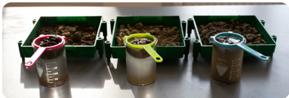
Fig. 4: Resultados de la prueba de estabilidad de agregados del suelo (ver la aplicación TUDI DST), aplicando un colador de té, vidrio y agua. La estabilidad de la estructura del suelo disminuye de izquierda a derecha.
