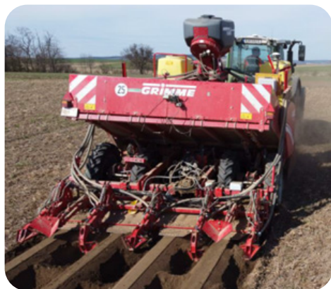
Fig. 1: Sembradora de patatas con aporcador de presa transversal.
