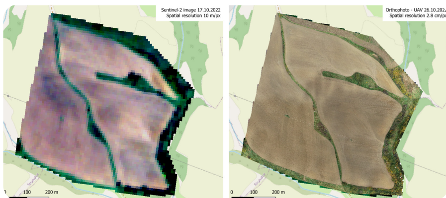
Фиг. 4: Сравнение на сателитно изображение в реални цветове Sentinel-2 с разделителна способност 10 м/пиксел и ортофотокарта, заснета от безпилотен летателен апарат с разделителна способност 2,8 см/пиксел, с видими ерозионни бразди, които могат да се използват и за по-подробен анализ, например за изчисляване на ерозирания материал.
