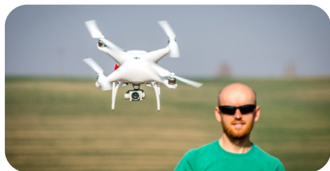
Фиг. 2: Малки и евтини дронове вече могат да заснемат данни от ортофотокарти с разделителна способност сантиметър на пиксел.
